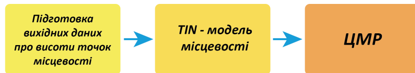
Рисунок 3 – Технологічна схема традиційного створення ЦМР на основі TIN-моделі
