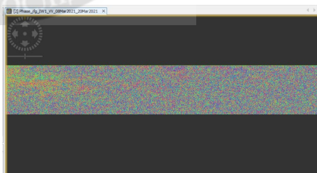
Рисунок 10 – Інтерферограма після використання інструменту S-1 TOPS Deburst для видалення швів між смугами (знімками)
