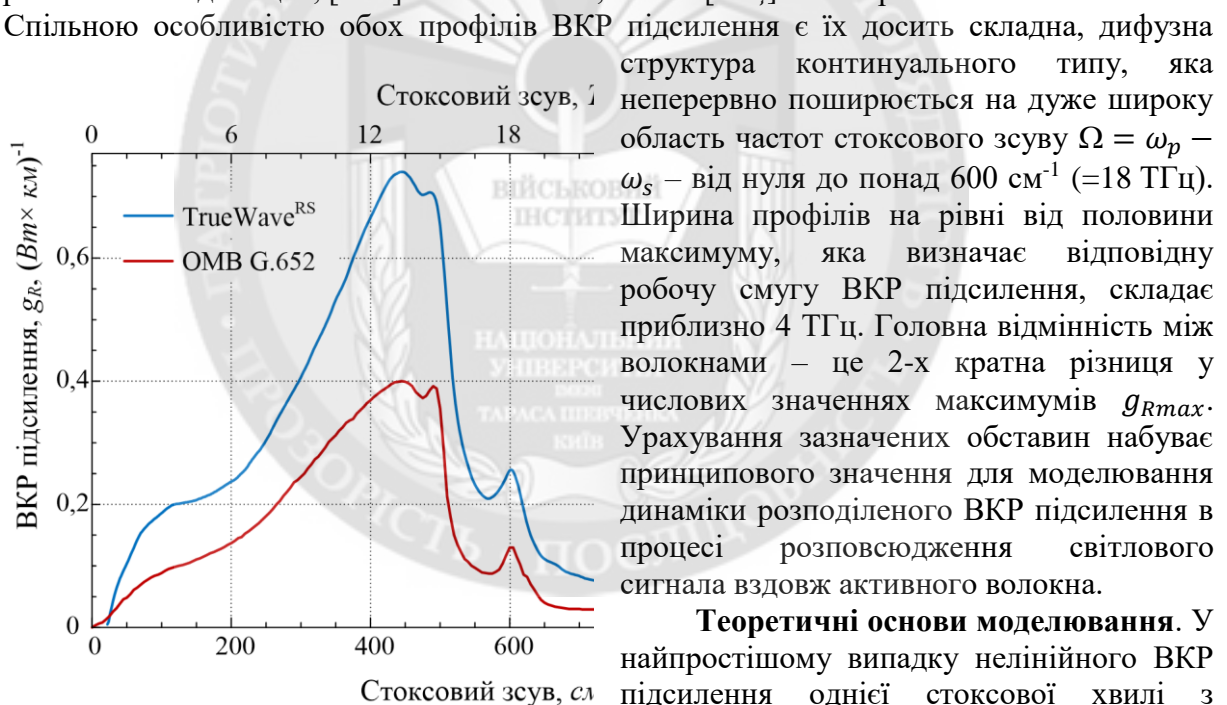
Рисунок - 2 Профілі ВКР підсилення двох стандартних одномодових волокон на основі кварцового скла
