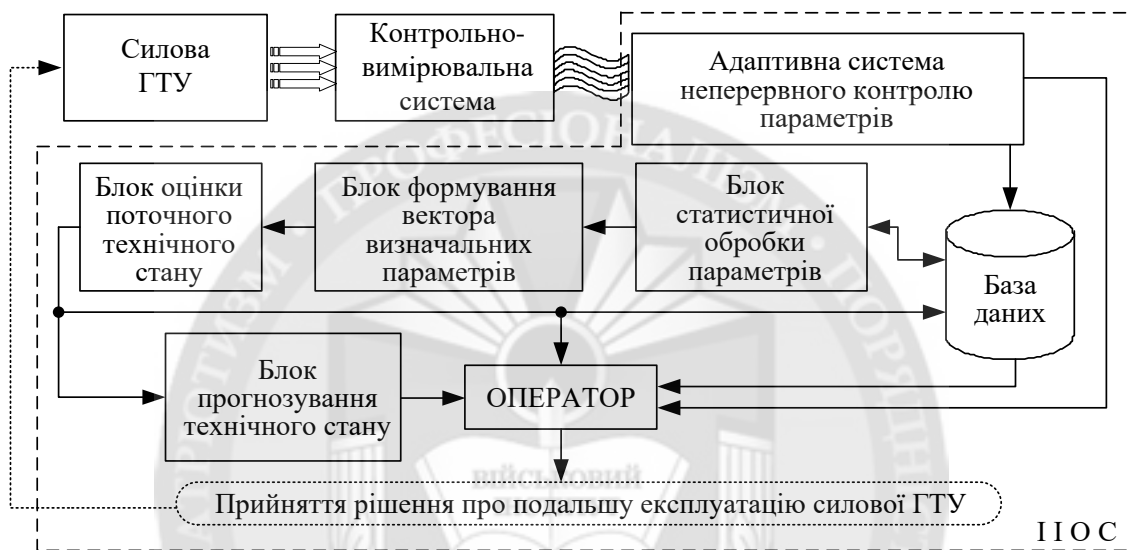
Рисунок 2 - Структурно-функціональна схема ІОС обробки параметрів, що характеризують поточний технічний стан силової ГТУ
