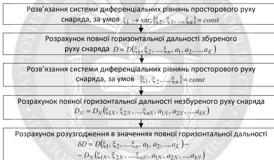
Рисунок 3 - Схема методики оцінки впливу похибки в дальності польоту снаряда від зміни величини аеродинамічного коефіцієнту SDM та PDM
