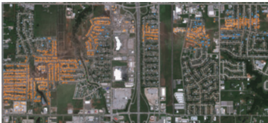
Рис. 1. За допомогою краудсорсингу за космічними знімками точно визначений кожен зруйнований будинок (помаранчевий колір) і кожна пошкоджений дах (синій колір) після торнадо в місті Мур, штат Оклахома, США
