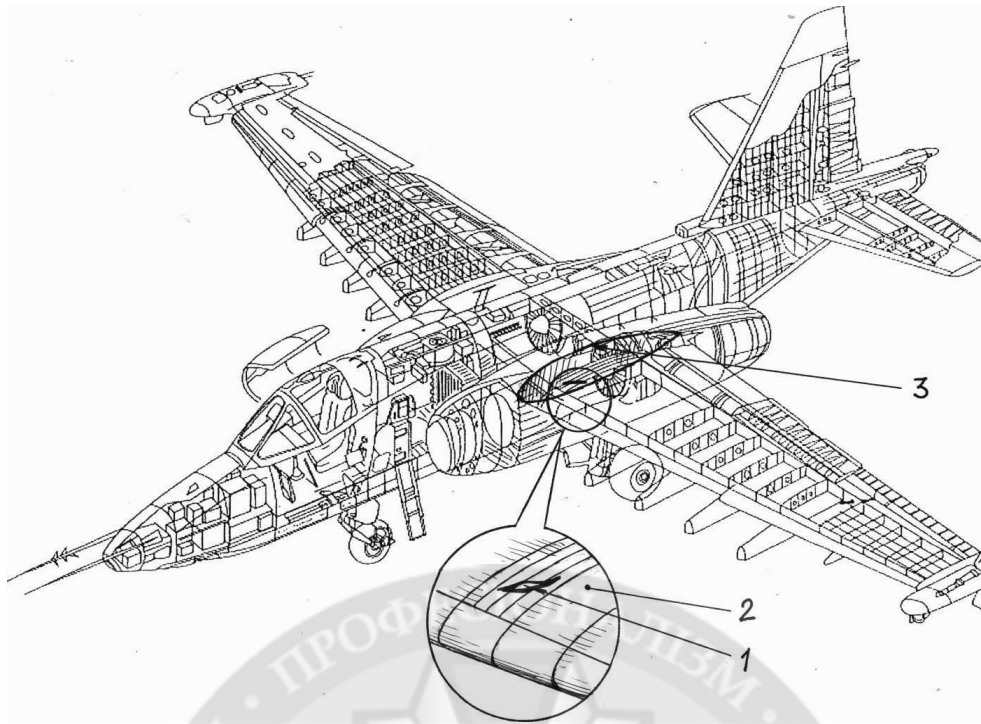
Рисунок 2 – Схема розміщення тріщини на верхній панелі крила літака типу Су-25
